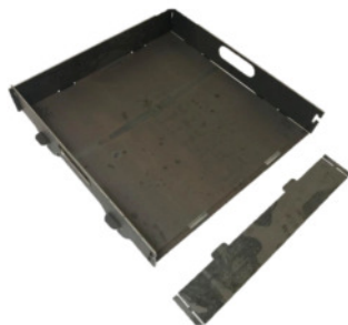
Bild 3: Komplettierung aller vier Seitenbleche an das Bodenblech
